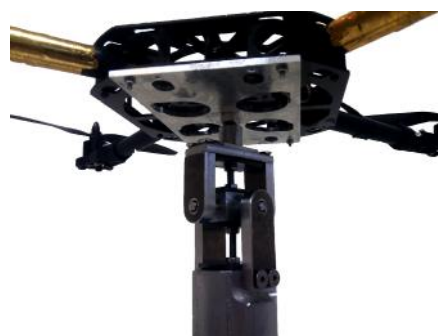
شکل ۱۲- نمایی از مکانیزم سه‌درجه آزادی چهارپره به‌منظور تست زاویه یاو.
