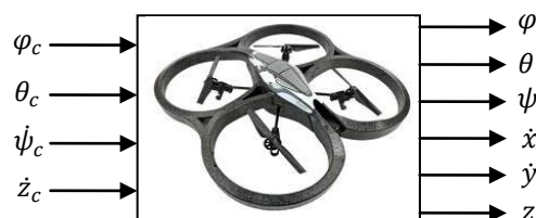
شکل ۱- دیاگرام جعبه‌ای کوادروتور از نظر ورودی و خروجی هدایتی
