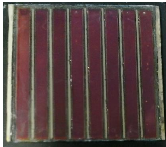
شکل ۳: ماژول خورشیدی ساخته شده با اعمال ضخامت بهینه فوتوالکتروسلول
