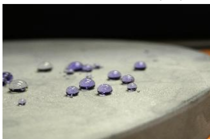
شکل ۲ نحوه قرارگیری قطره آب بر روی سطح دیسک بعد از اعمال پوشش.
