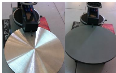
شکل ۵ انجام زبری سنجی بر روی دیسک صاف و سندبلاست شده.
