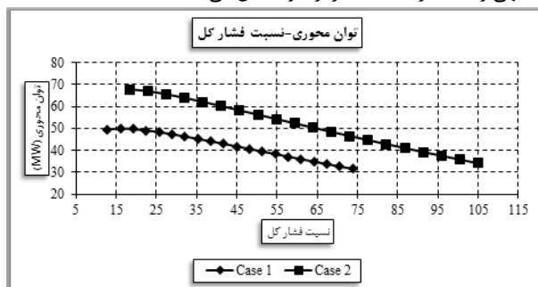
شکل (32) تغییرات توان محوری بر حسب نسبت فشار کل موتور برای توربین‌های گاز صنعتی مشتق‌شده از موتور هوایی Trent 800.
