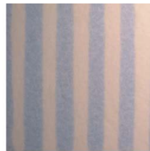
شکل ۱۱: استفاده از مواد هوشمند تغییر رنگ دهنده ( ترموکرومیک ) در پارچه های مورد استفاده در مبلمان داخلی [۱]
