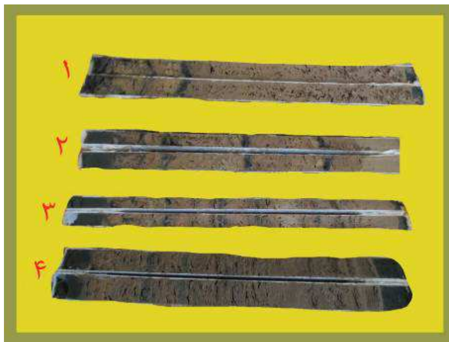
شکل ۴- تصویری از مغزه‌های برداشته شده از رسوبات مخزن سد کارده
