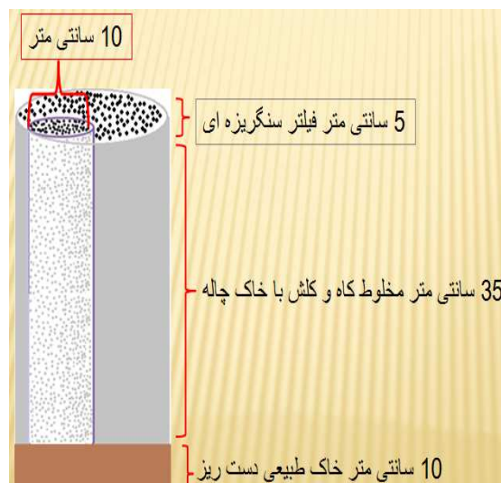
شکل ۲- نحوه اعمال تیمار ۲ با فیلتر سنگریزه ای در عمق چاله را نشان می دهد
