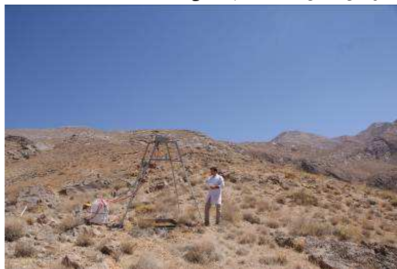
شکل ۲- شبیه ساز باران مورد استفاده
