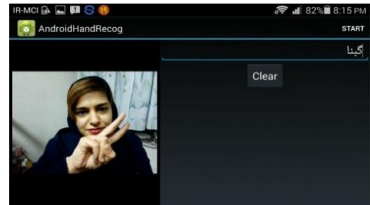
شکل ۱۰: تشخیص نادرست دست از صورت و تبدیل نادرست به
