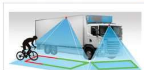
شکل شماره ۱- سامانه هوشمند شناسایی نقاط کور
