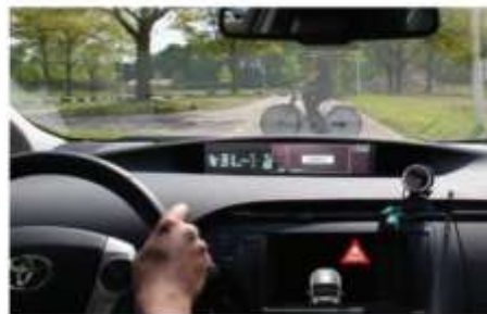
شکل شماره ۴- سامانه هوشمند شناسایی عابر پیاده و دوچرخه سوار به همراه ترمز گیری اضطراری
