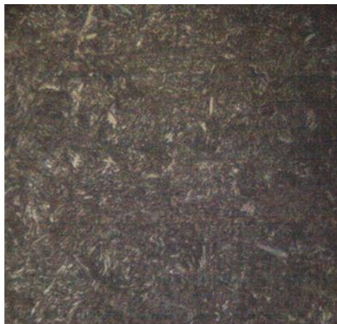
شکل ۷- ساختار مارتنزیت تمپر شده در سطح برش خورده فولاد CK45 با سختی ۵۰ راکول ماشینکاری با سیم نقره‌ای (بزرگنمایی X500)
