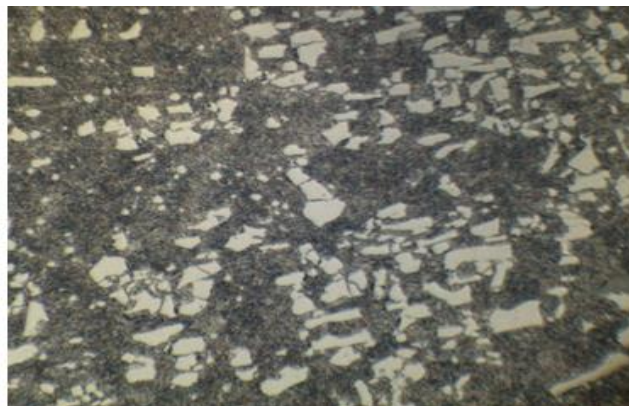
شکل ۷- توزیع ذرات کاربید در زمینه مارتنزیت تمپر شده در فولاد SPK با سختی ۵۴ راکول ماشینکاری با سیم نقره‌ای (بزرگنمایی X500)
