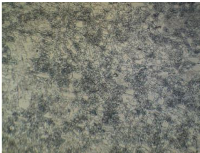
شکل ۸- توزیع ذرات کاربید در زمینه پرلیتی به همراه جزایر مارتنزیتی در فولاد SPK خام بدون سختی ماشینکاری با سیم نقره‌ای (بزرگنمایی X500)
