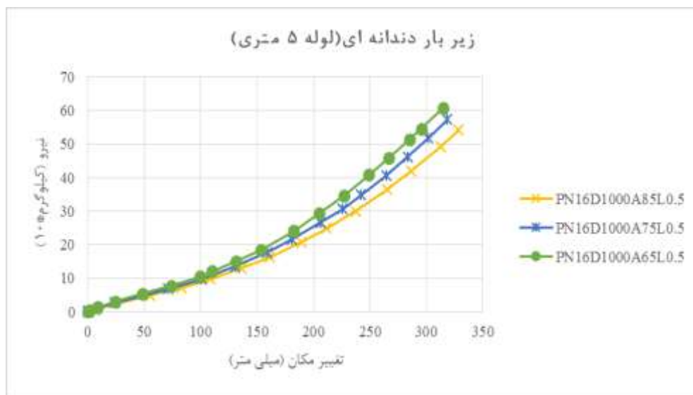
شکل ۸- منحنی بار-تغییر مکان لوله ها در زیر گوه با نسبت دهانه به قطر ۵ و نسبت قطر به ضخامت ۹۵/۲۴ و محل بار وسط دهانه
