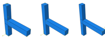
شکل ۳: نمایی از مدل سازی سه نوع تیپ اتصالات تیر به ستون کناری ساختمان بدون ورق FRP (از چپ به راست به ترتیب تیپ های اول، دوم و سوم)
