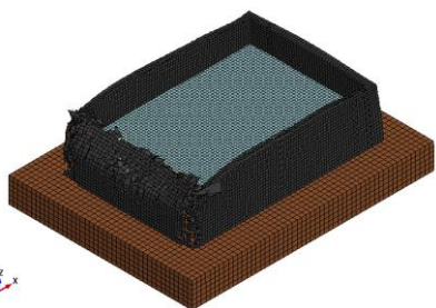
شکل ۱۰: نمای سازه پس از انفجار عرضی تی‌ان‌تی با جرم ۱۰۰۰ کیلوگرم در فاصله ۲ متری
