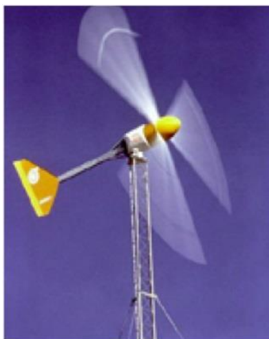
شکل ۱ نمونه ای از توربین های باد خانگی از نوع محور افق [۳]
