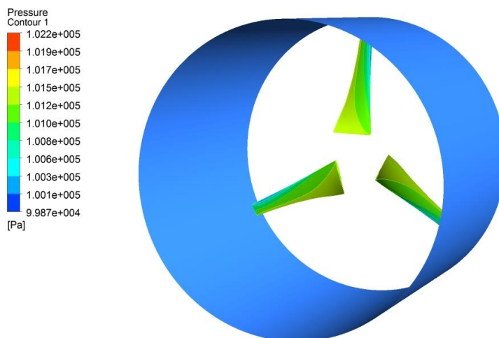
شکل ۴-۱۸ مقادیر فشار پره برای کانال با طول ۱ متر و نسبت خروجی به ورودی ۱/۱۸
