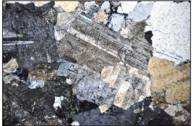
(شکل ۶) نمونه گرانودیوریتی با بافت گرانولار دارای کوارتز و پلاژیو کلازها از نوع آلیت تا الیگوکلاز و آمفیبول و بیوتیت . بر روی فلدسپاتها، کمی
