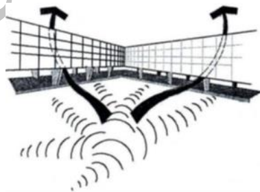
شکل ۳- تخلیه سریع نیروهای انفجاری از زیر ساختمان
