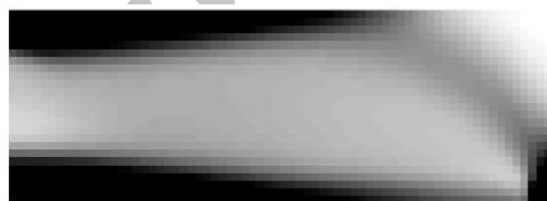
تصویر ۱۱- در تلاش ۵ ام ، شعاع فیلتراسیون ۱ ، ضریب پنالتی در این مرحله ۱,۵ ، تابع هدف ۱۶۷,۰۱
