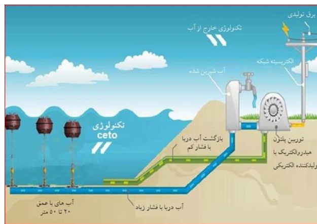
شکل ۲۰- نمک‌زدایی آب با استفاده از انرژی امواج
