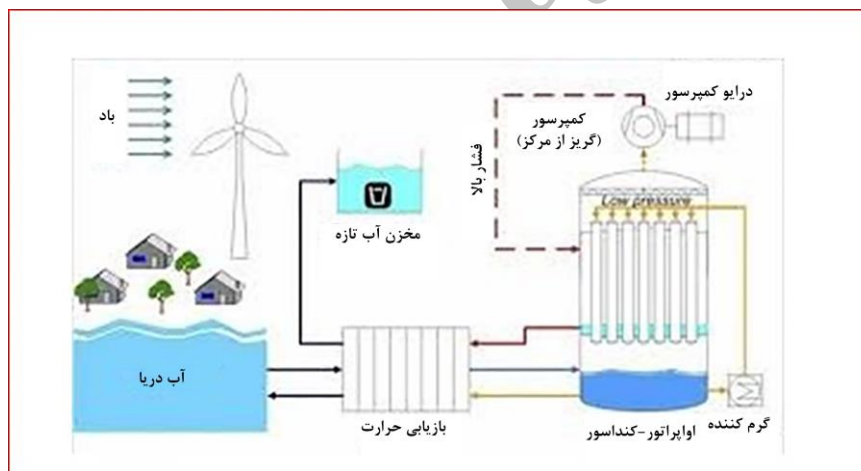
شکل ۱۷- نمک‌زدایی آب با استفاده از انرژی باد
