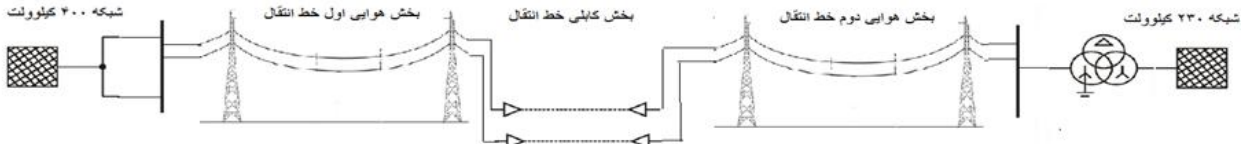
شکل 6: ساختار کلی خط انتقال تحت مطالعه
