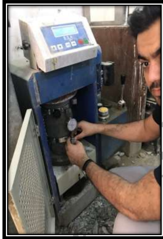
شکل ۵- نمایی از انجام آزمایش ضریب ارتجاعی استاتیکی نمونه‌ها
