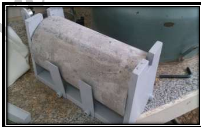
شکل ۴- نمایی از روند انجام آزمایش مقاومت کششی به روش دونیم شدن
