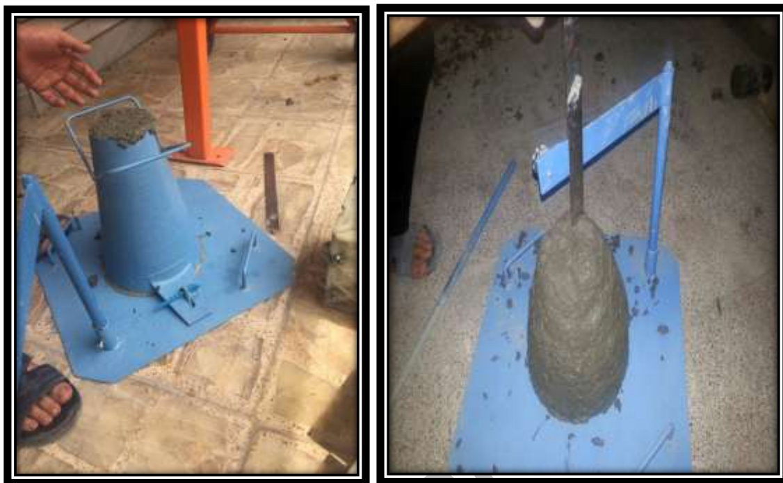
شکل ۲- نمایشی از انجام آزمایش اسلامپ در بتن تر
