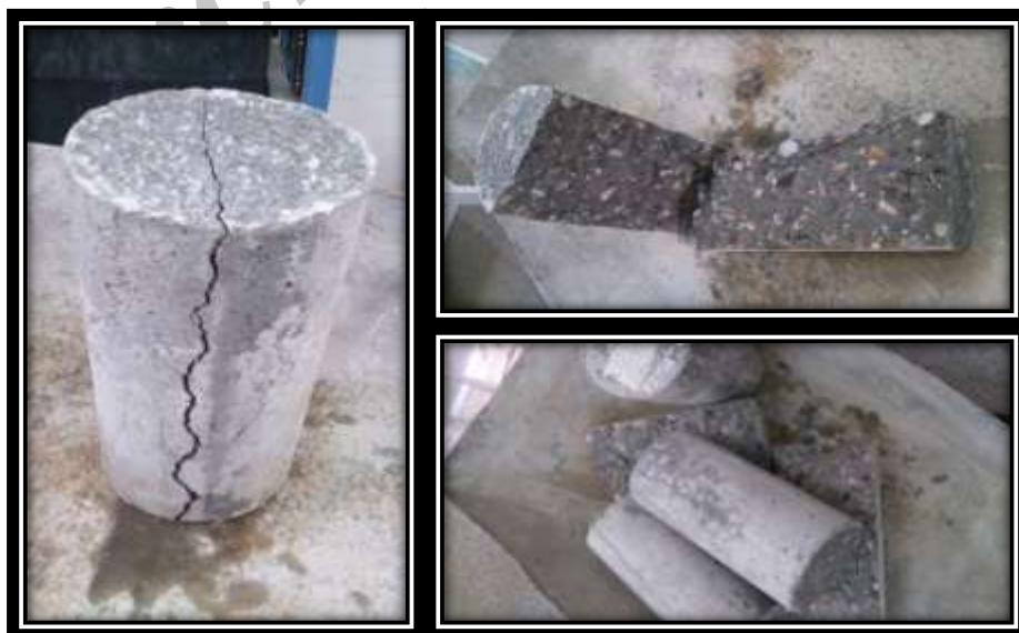
شکل ۴- نمایی از انجام آزمایش مقاومت کششی به روش دونیم شدن
