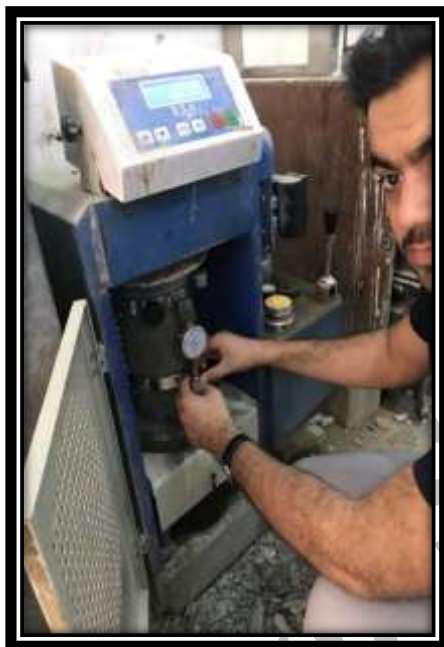
شکل ۵- نمایی از انجام آزمایش ضریب ارتجاعی استاتیکی بتن
