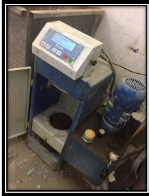
شکل ۳- نمایی از جک بتن شکن استفاده شده در تحقیق
