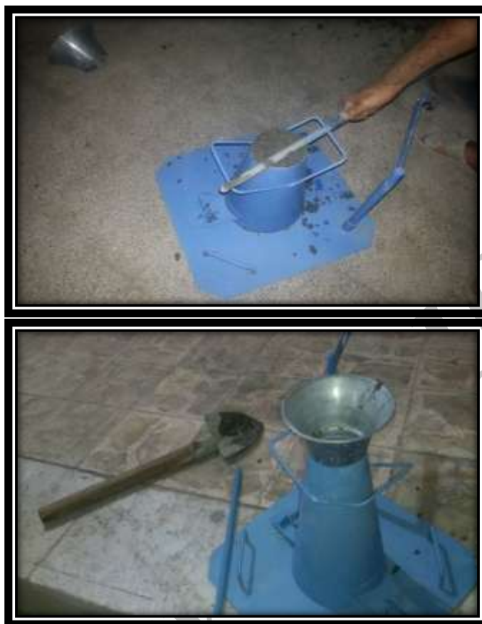
شکل ۲- نمایی از روند انجام آزمایش اسلامپ بتن
