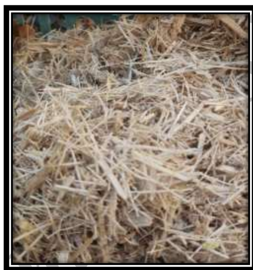
شکل ۱- نمایی از الیاف باگاس استفاده‌شده در تحقیق
