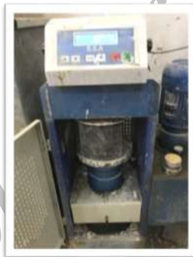
شکل ۳- انجام آزمایش مقاومت فشاری با استفاده از جک بتن شکن
