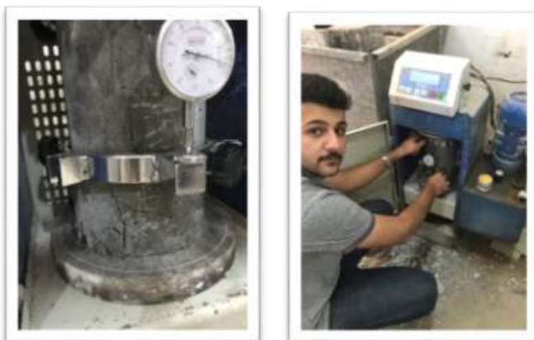
شکل ۵- نمایی از انجام آزمایش ضریب ارتجاعی استاتیکی نمونه‌های بتن
