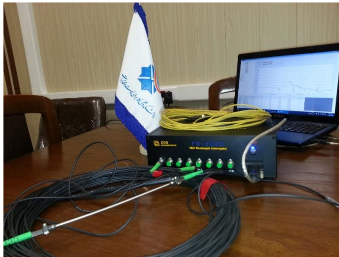
شکل ۱-۱ مدل آزمایشگاهی سامانه سلامت سنجی مبتنی بر FBG (دانشکده علمی کاربردی پست و مخابرات)
