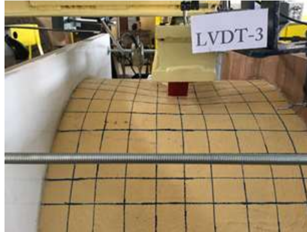
شکل ۱۰: تغییر شکل مخزن پس از اعمال بار دنت
