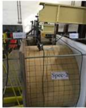
الف- نمونه آزمایشگاهی دوم و محل قرارگیری کرنش سنج - LVDT, LVDT
